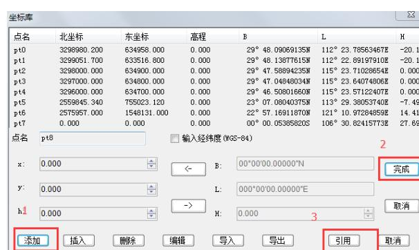
图 10-21 通过编辑框直接添加导航坐标平面坐标
