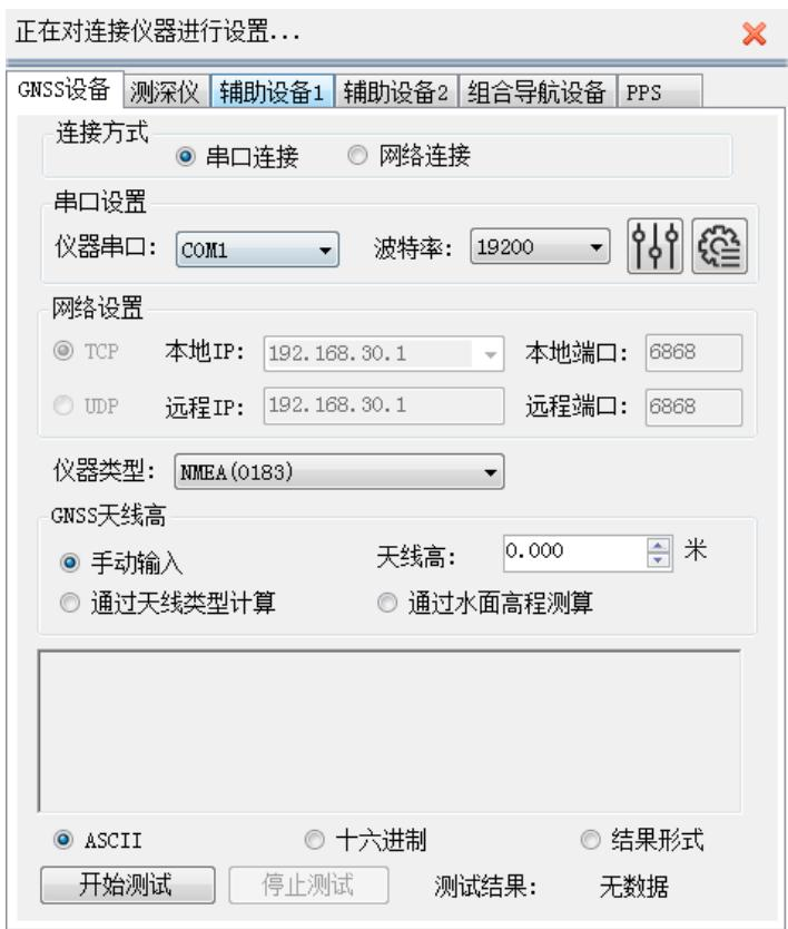
图 5-1 GPS 串口设置
