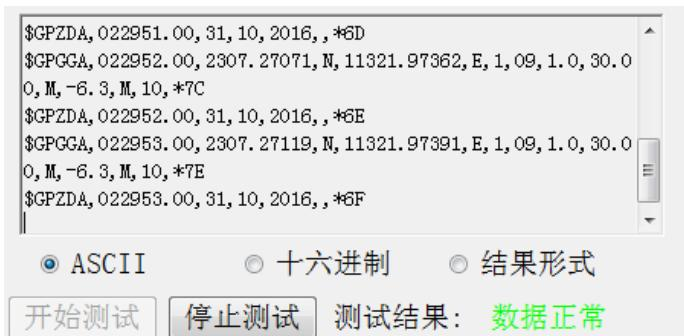
图 5-6 ASCII 码显示
