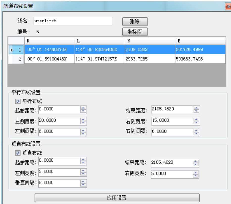
图 7-25 航道计划线编辑界面
