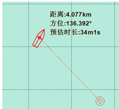
图 10-23 测量窗口显示的定点导航信息
