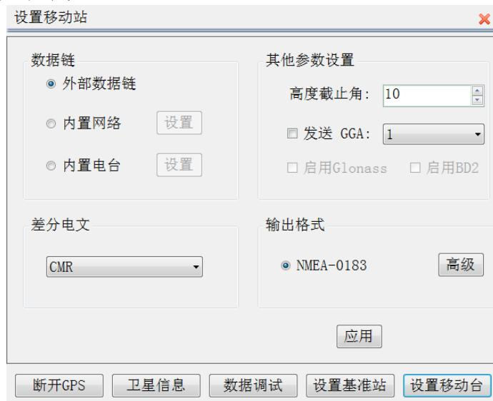
图 15-17 RTK 移动站设置
